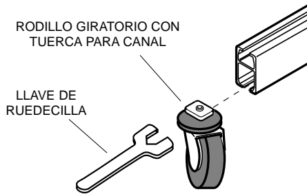
Figura 9. INSTALACIÓN DE RODILLOS
